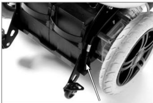
Фиг. 6 кабель батареи на контактной шине
