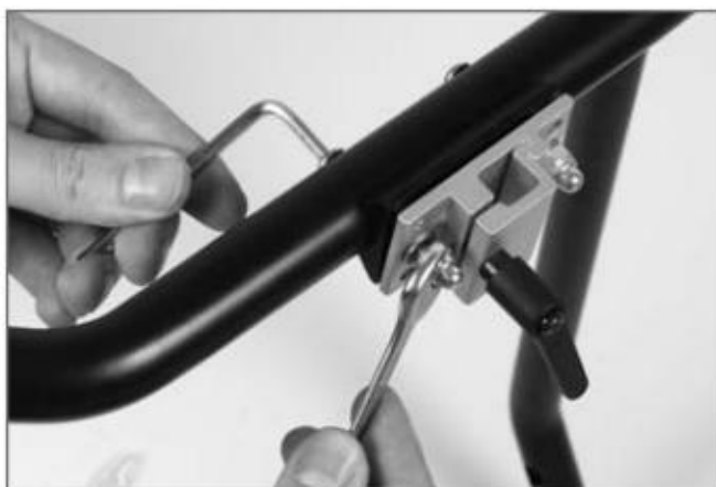
Фиг. 45 установка подголовника из монтажного комплекта
