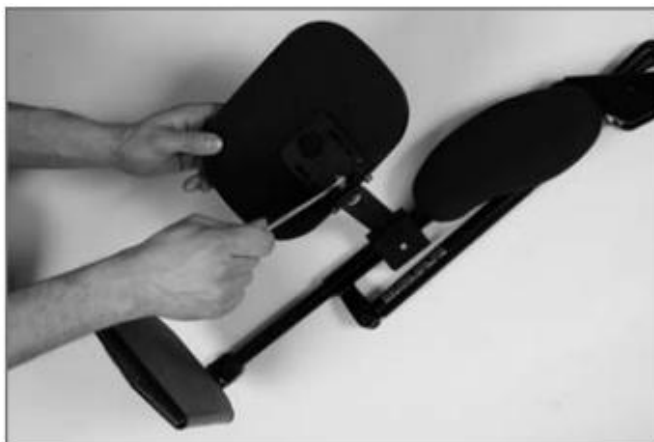
Фиг. 18 замена козелка спусковой площадки
