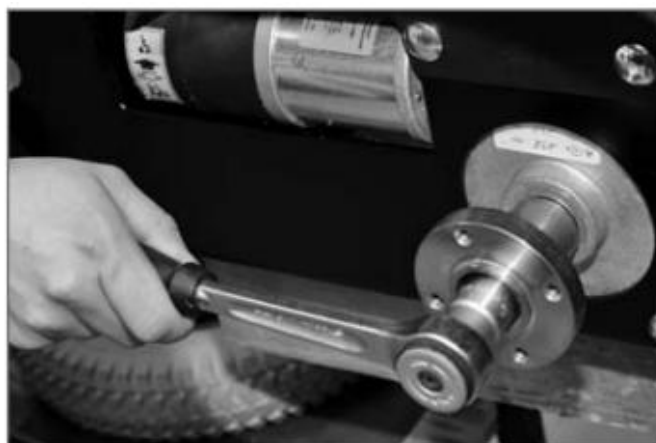
Фиг. 22 откручивание винтов колесных фланцев
