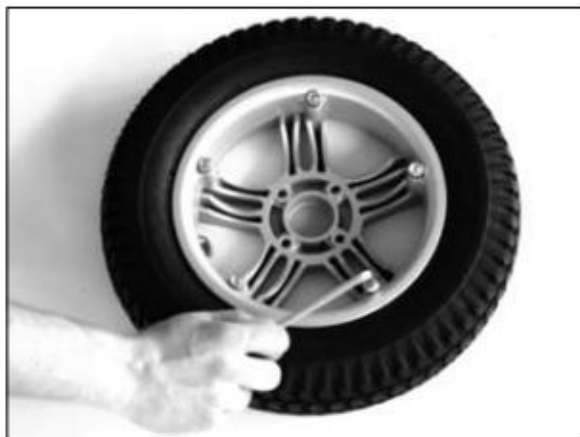
Фиг. 20 снятие кожуха
