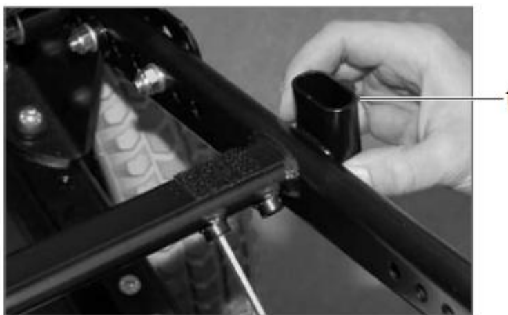
Фиг. 36 замена боковой панели крепления устройства
