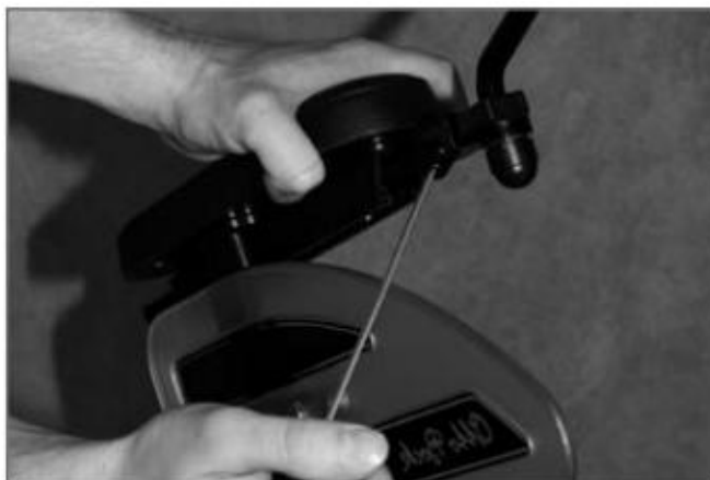
Фиг. 44 постзаводская установка зеркала заднего вида
